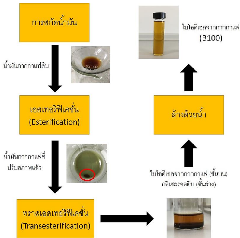
ภาพที่ 2 แสดงกระบวนการผลิตไบโอดีเซลจากกากกาแฟ โดย Tuntiwattanapun (2019)
